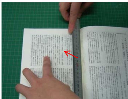
おもて面に定規を傾けながら、のどに向かってページをさらに押し込む
