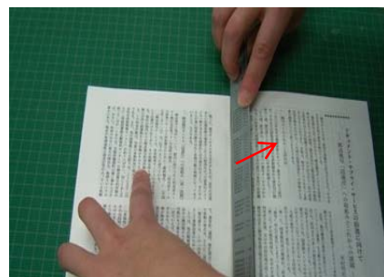
定規を反対側に傾け、静かにはずす
